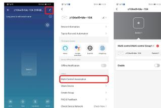
4.Wählen Sie den Schalter aus, dem Sie assoziieren möchten, und wählen Sie dann die Schaltertaste, mit der Sie dasselbe Licht steuern möchten.
